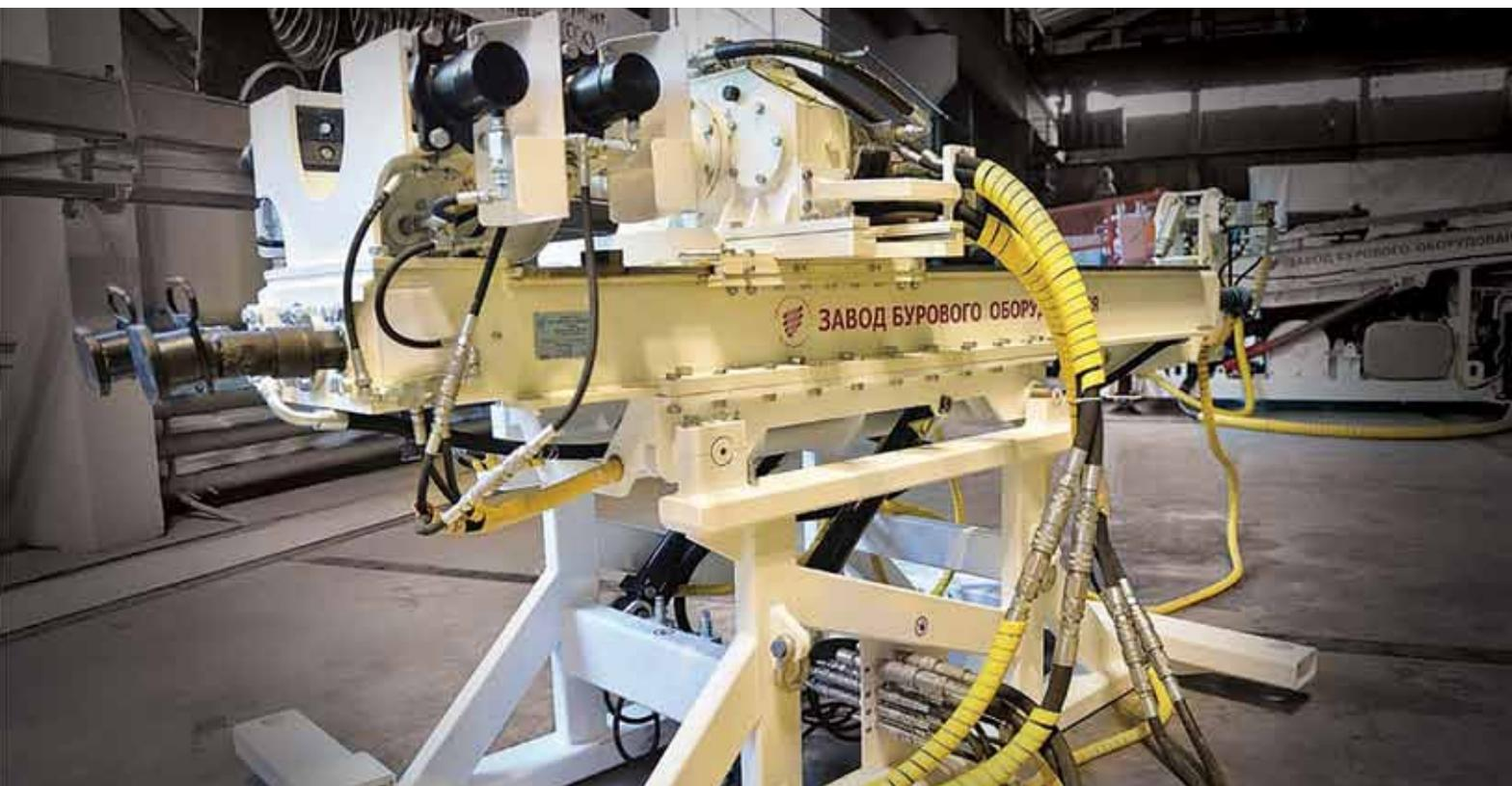
**ZBO U15A** подземная гидрофицированная буровая установка для бурения полного вертикального веера дренажных, дегазационных, технологических, разведочных скважин из подземных выработок и в бортах карьеров, угольных разрезов и строительных котлованов
