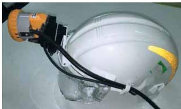
Рис. 4. Комплексный СИЗ для защиты шахтеров Airstream российской сборки
