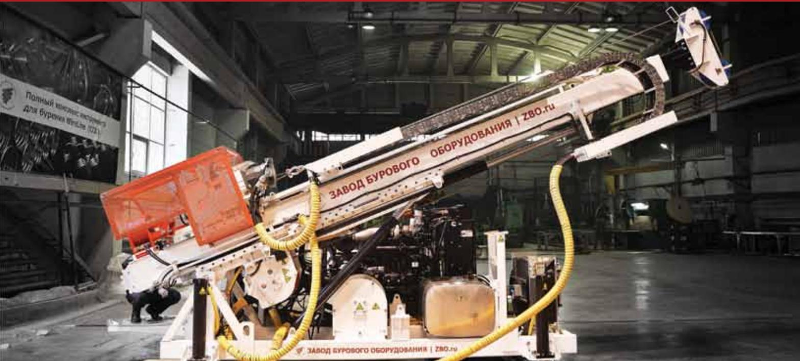
**ZBO S15** наземная гидрофицированная буровая установка для высокоскоростного алмазного разведочного бурения для скважин глубиной до 1260 м.
