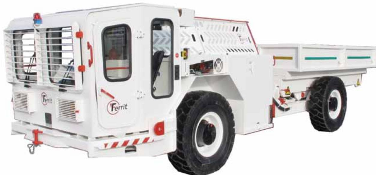
Шахтный тягач на колесном ходу чешской фирмы Ferrit — универсальное средство для манипуляции и транспортировки кассет, предназначенных для специфического применения (в зависимости от вида кассеты) в тяжелых горных условиях, в среде с опасностью взрыва газа и угольной пыли. Именно высокая взрывобезопасность — одно из главных его достоинств. Тягач используется как в низкопрофильных подземных шахтах, так и в больших подземных пространствах, в процессе добычи и проходки тоннелей, при строительстве.
